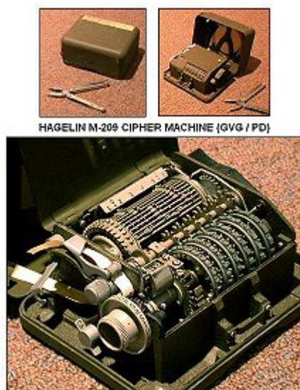
Рис. 3. Криптографическая машина «М-209»
